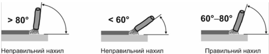
Рисунок 3. Кут розташування електрода із покриттям до деталі під час ручного дугового зварювання (ММА).
