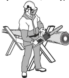
Рисунок 11. Схема розпи́лу колоди з використанням козових опор.
