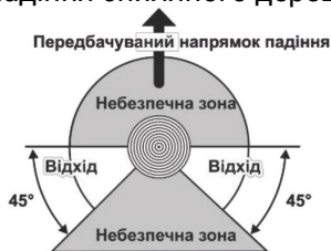
Рисунок 8. Схема зони падіння дерева.
