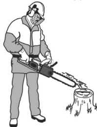
Рисунок 4. Схема перевірки системи подачі мастила.
