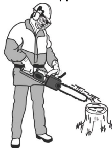
Рисунок 4. Схема перевірки системи подачі мастила.
