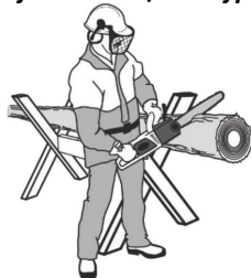
Рисунок 11. Схема розпилу колоди з використанням козових опор.
