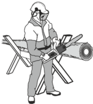
Рисунок 13. Схема розпилу колоди з використанням козових опор.
