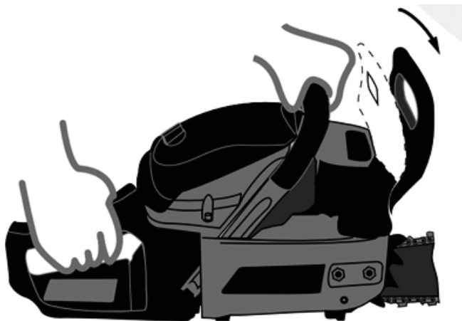
Рисунок 5. Схема роботи гальма ланцюга.
